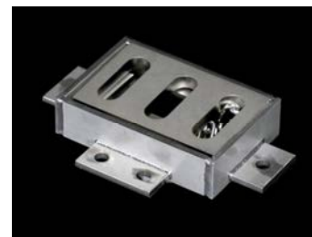
目皿をボルト固定していない例（チェーンあり）
