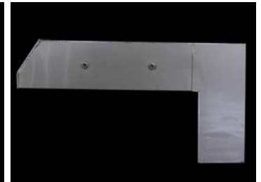
地覆形状に合わせ目皿を曲げています
