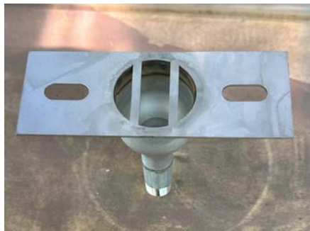
製作した製品形状 (TSあとからフレキをベース → P.106)
