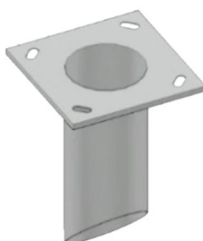
天板プレート一体型排水装置 φ125 例1 [TS-PL_PIPE-L-125-101]
