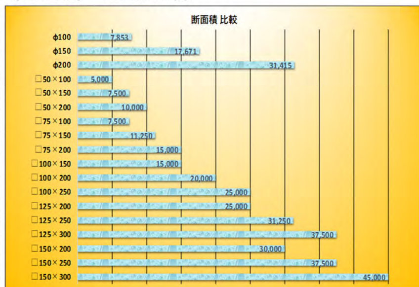
Φ(丸パイプ) / □(角パイプ) 断面積 比較
