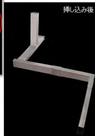
・角管でソケット形状仕様の製作例
