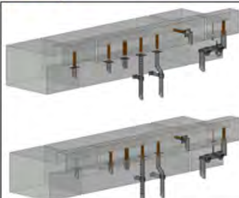
天板プレート一体型排水管 φ125 例1 [TS-PL_PIPE-L-125-101]
